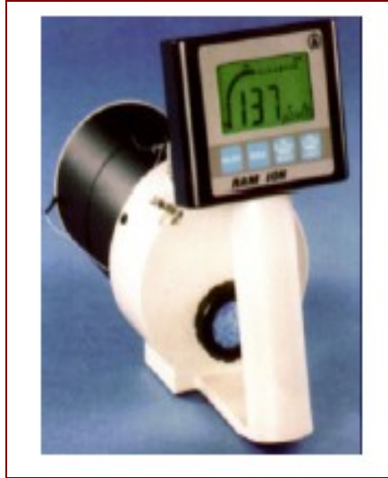
FIGURA 3.7 – CÂMARA DE IONIZAÇÃO PRESSURIZADA PORTÁTIL
