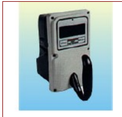
FIGURA 3.7 – CÂMARA DE IONIZAÇÃO PRESSURIZADA PORTÁTIL
