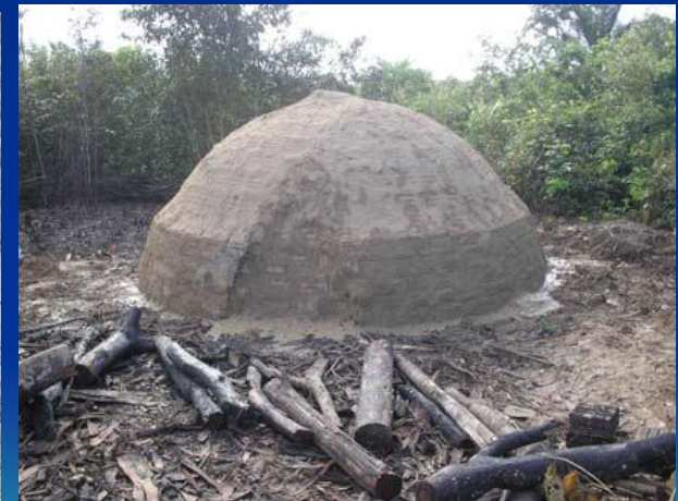
Acendimento do forno com (a) colocação de lenha pelo topo e (b) fechamento da baiana principal com início de emissão de fumaça (C) a fumaça esbranquiçada revela início da combustão da lenha
