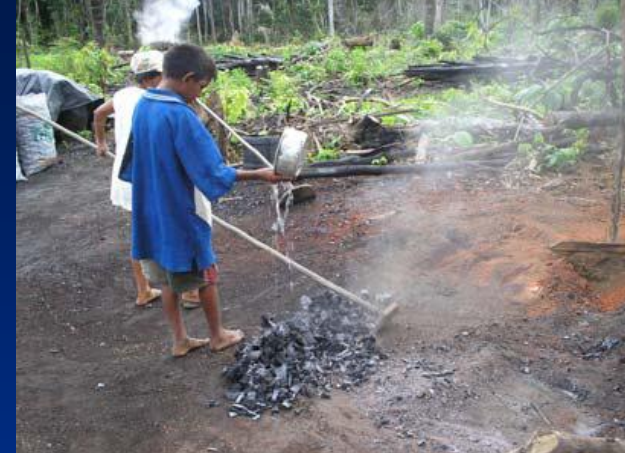
Produção de carvão vegetal em (a) caiaira, (b) separação da terra, e (c) apagando o fogo do carvão com água (Silva, 2006)
