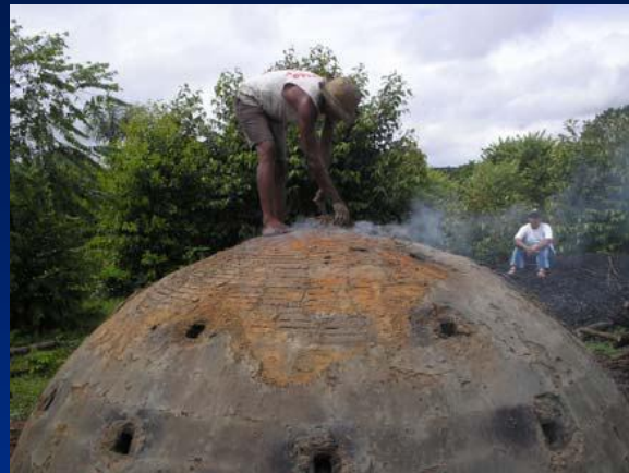
Acendimento do forno com (a) colocação de lenha pelo topo e (b) fechamento da baiana principal com início de emissão de fumaça (C) a fumaça esbranquiçada revela início da combustão da lenha
