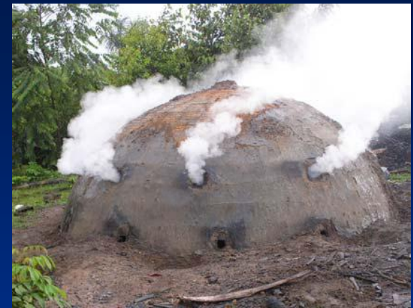
Acendimento do forno com (a) colocação de lenha pelo topo e (b) fechamento da baiana principal com início de emissão de fumaça (C) a fumaça esbranquiçada revela início da combustão da lenha
