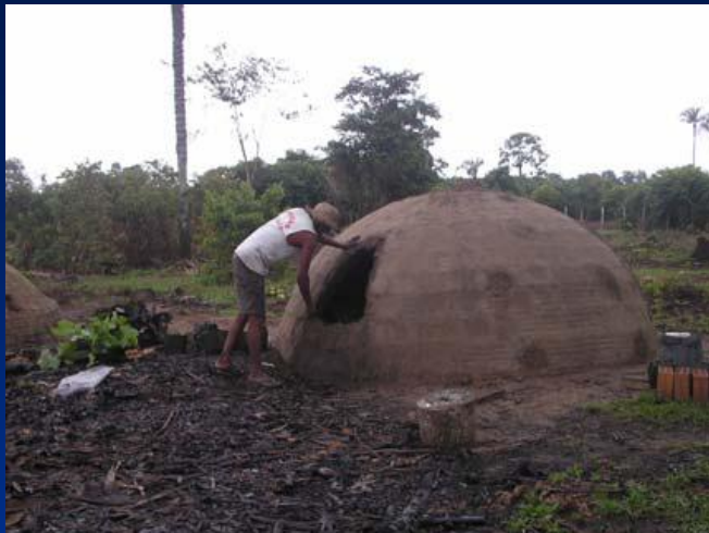
Abertura do forno após 3 a 4 dias de abafamento
