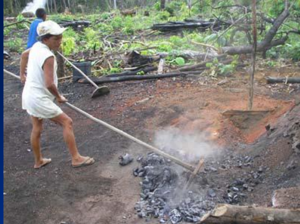
Produção de carvão vegetal em (a) caiaira, (b) separação da terra, e (c) apagando o fogo do carvão com água (Silva, 2006)
