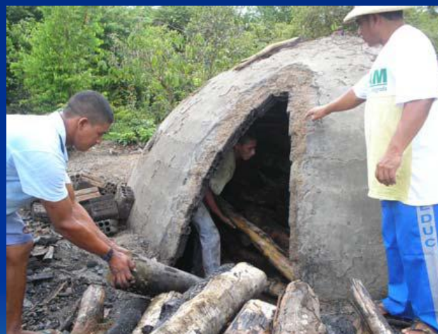
Forno de tijolos + carregamento da lenha para o interior do forno + fechamento da porta principal antes de acender o forno
