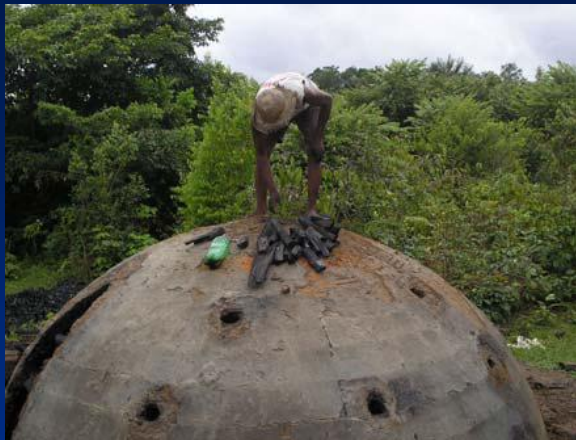
Acendimento do forno com (a) colocação de lenha pelo topo e (b) fechamento da baiana principal com início de emissão de fumaça (C) a fumaça esbranquiçada revela início da combustão da lenha
