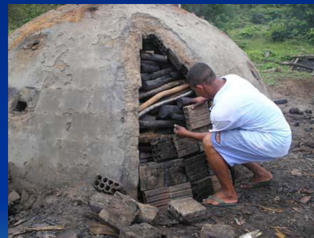
Forno de tijolos + carregamento da lenha para o interior do forno + fechamento da porta principal antes de acender o forno
