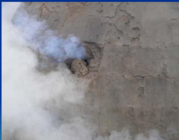
A fumaça azul indica que a baiana pode ser fechada. A figura central mostra um tatu após seu fechamento e a seguinte o forno barrelado (barreado)
