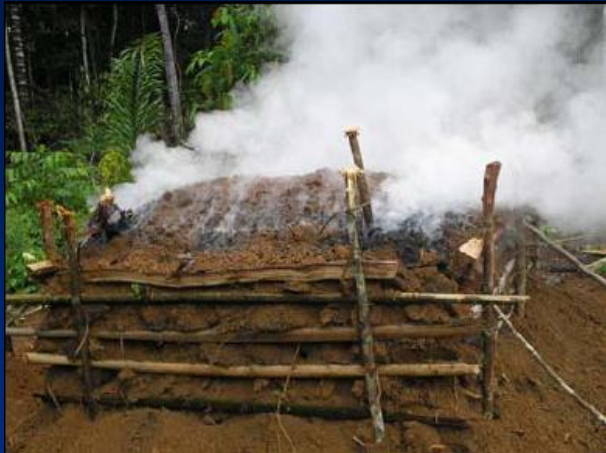
Produção de carvão vegetal em (a) caiaira, (b) separação da terra, e (c) apagando o fogo do carvão com água (Silva, 2006)
