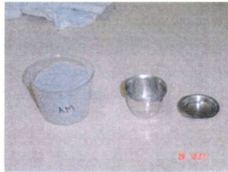
Figura 6.8 – Fotos da amostra moída e ao lado o cadinho de platina/ouro.
