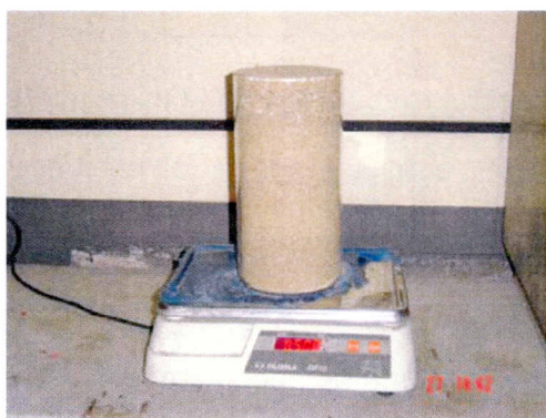
Figura 6.6 – Foto do recipiente completamente cheio e "rasado", sendo pesado.
