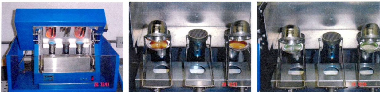
Figura 6.9 – Fotos seqüenciais da formação das pastilhas fundidas: fusão, resfriamento e solidificação.
