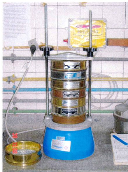
Figura 6.3 – Fotos da balança e do peneirador vibratório, usados nos ensaios da série normal de peneiras.
