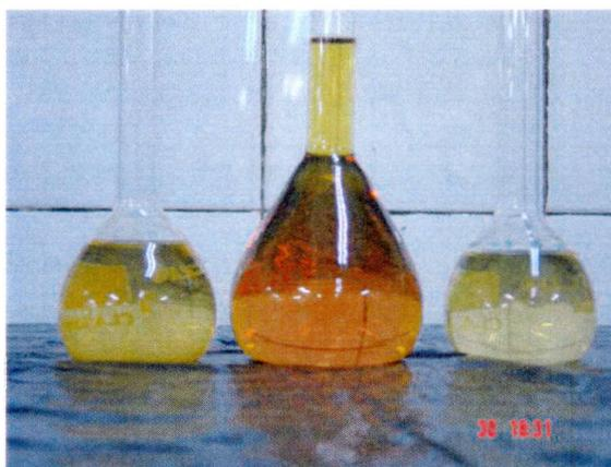
**Figura 7.2 – Resultados do ensaio de determinação colorimétrica do teor de matéria orgânica:**
