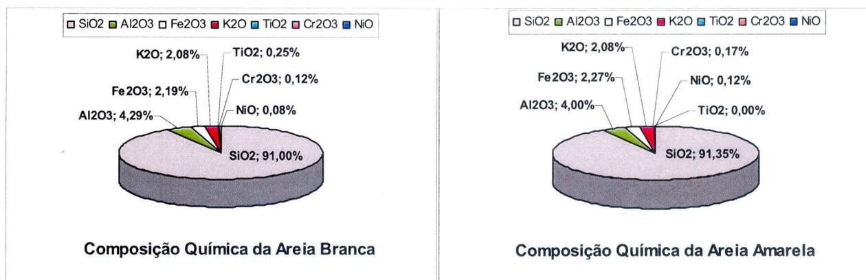
**Figura 16 – Gráficos em formato pizza representativos das composições químicas das amostras de areia coletadas em Seropédica-Itaguaí, RJ, determinada nas análises por Fluorescência de Raios X.**
