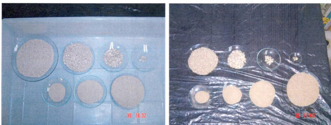
**Figura 7.5 – Visão aproximada das frações granulométricas da areia branca e amarela, separadas nos ensaios para determinação granulométrica utilizando a série normal de peneiras.**
