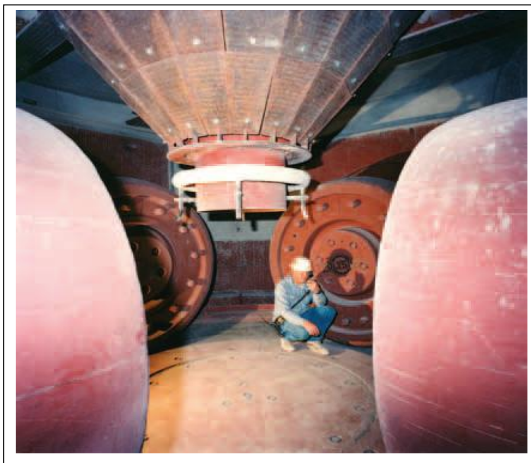
Figura 6.25 - Interior de um moinho vertical de rolos QUADROPOL (Polysius, 2011)
