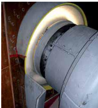
Figura 6.15 - Vedação do rolo (FLS-Smidht, 2011)
