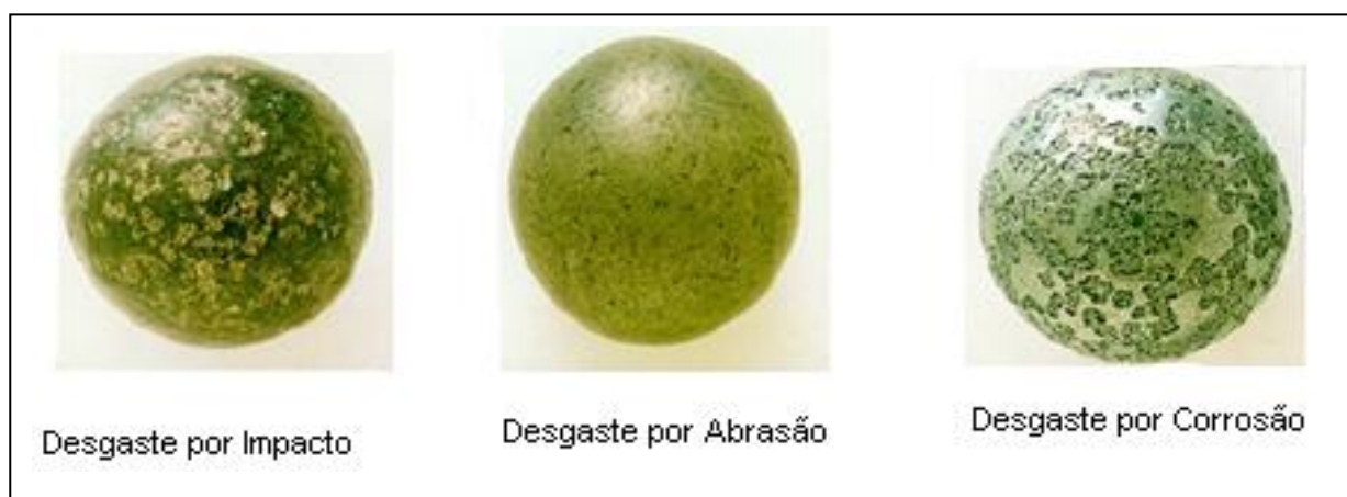
Figura 5.7 - Desgaste de corpos moedores (Silva, 2007)
