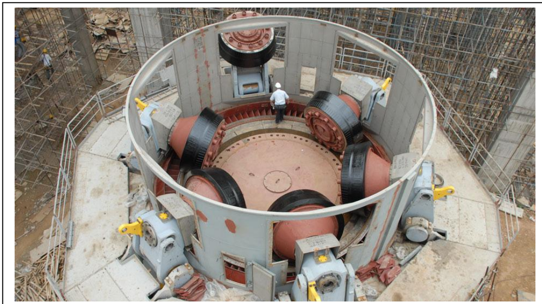
Figura 6.28 - Mesa de moagem de um moinho vertical de rolos inclinados (Loesche, 2011)
