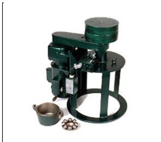
Figura 4.2- Máquina para ensaios de moabilidade de Hardgrove (Preiser, 2011)
