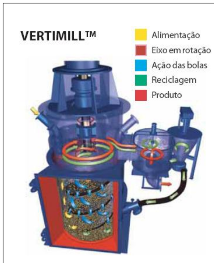
Figura 2.16 - Esquema de moagem do VERTIMILL. (Metso, 2011)
