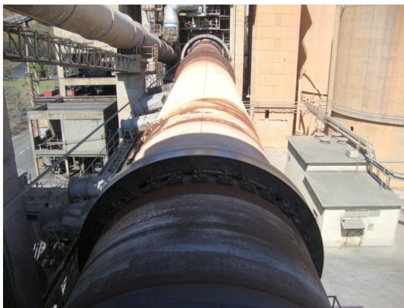
Figura 2.6 - Forno rotativo de clinquerização em Cantagalo, RJ (Lafarge, 2011)
