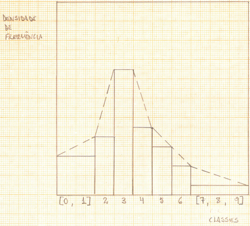
Fig. 12 - HISTOGRAMA E POLÍGONO DE DENSIDADES DE FREQUÊNCIA (OBTIDO PELOS PONTOS EXTREMOS EXTERNOS DO HISTOGRAMA)
